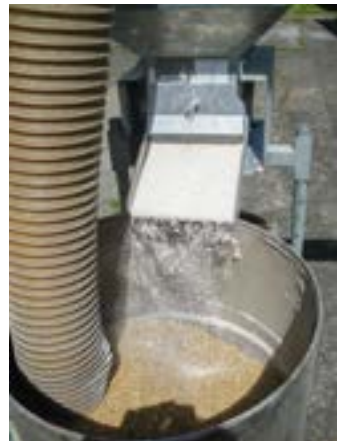
Applikator für die Einmischung von Silico-Sec in Getreide, rechts eine Druckluftpistole für die Leerraumbehandlung. Beide Geräte können auf Anfrage bei Andermatt Biocontrol Suisse bezogen werden.
